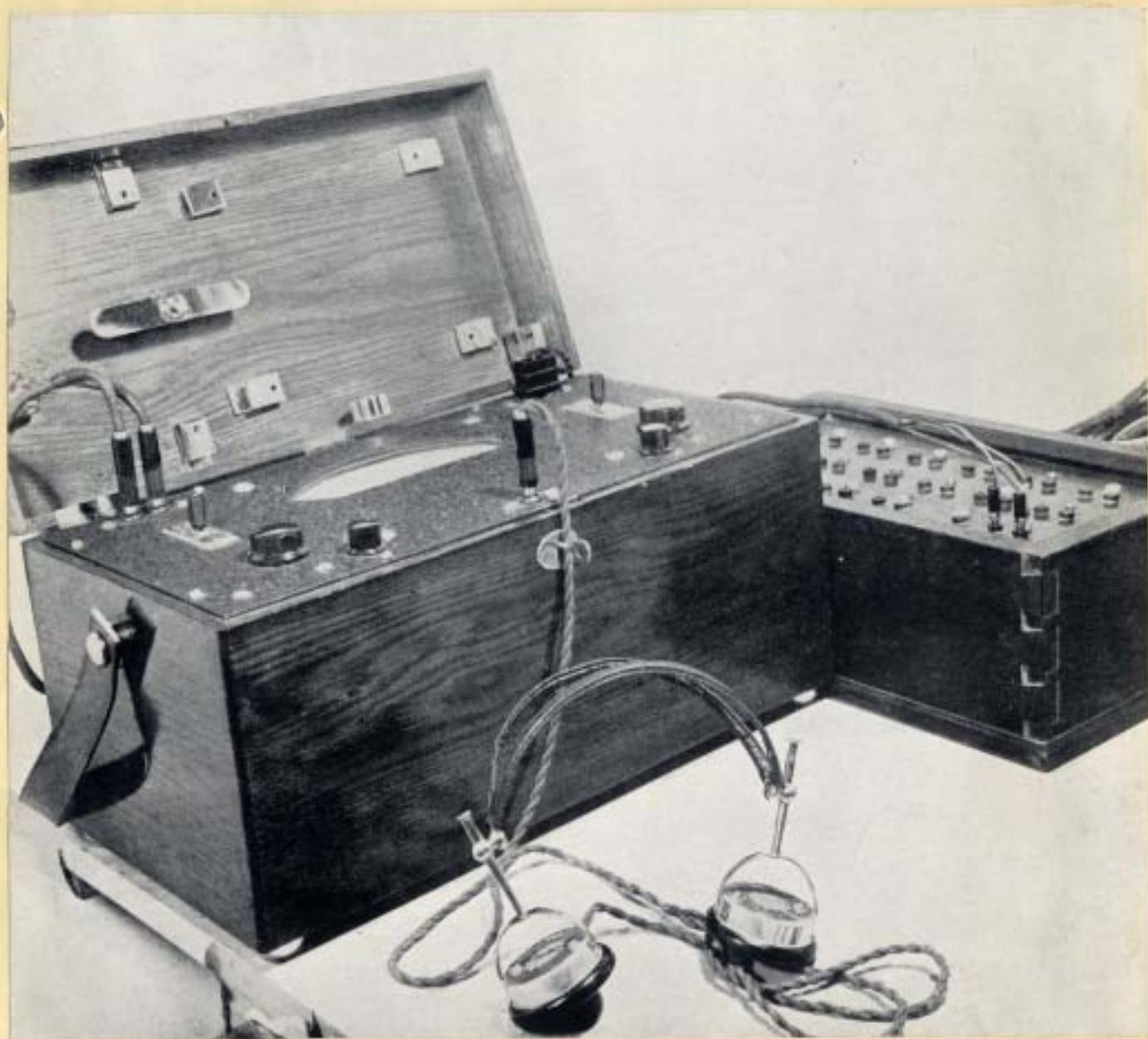
Fig 25 - Telermicro-deformetro para lectura
